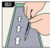
電極を砥石ホイール(図1)もしくは砥石ベルト(図2)に注意しながら近付けます
