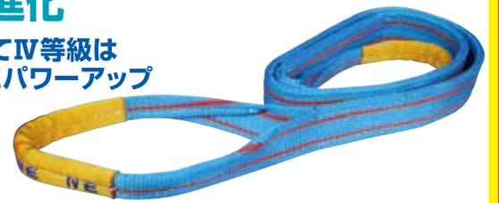
ポリエステルを使用しているのほとんど吸水せず耐候性も抜群、さらに寸法変化も少ない/ポリエステル原着糸を使用しているのでも色落ちが少ない/ベルト表面に幅が一目でわかるオレンジラインを継続/アイ部に「IV」を印字する事によりⅢ等級との混在を回避/ベルトに織り込まれた白色の芯糸により使用限度が一目でわかる
