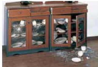
◀施工例 左がフィルムを貼ったガラス、 右が貼っていないガラス
