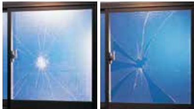
◀施工例 左がフィルムを貼ったガラス、 右が貼っていないガラス
